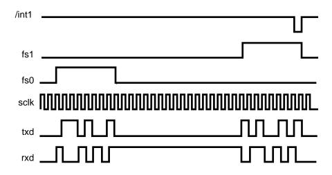
Figure 10. CODEC Interface Timing (8-Bit Mode)
